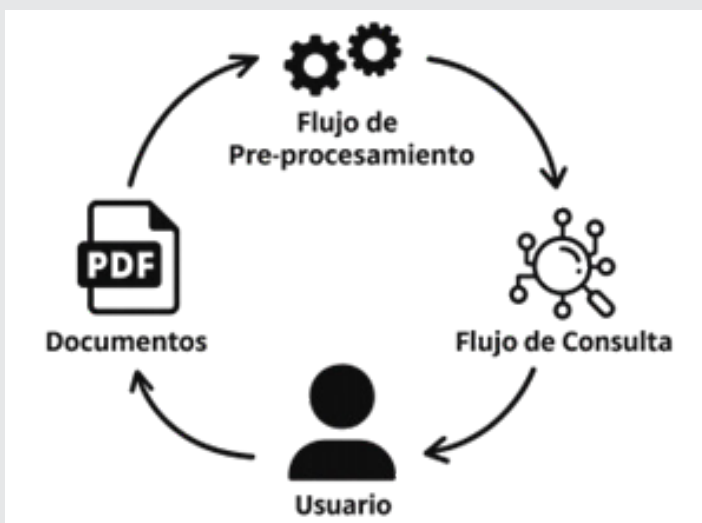
Figura 1. Diagrama a bloques de la aplicación web para exámenes rápidos con IA generativa.
